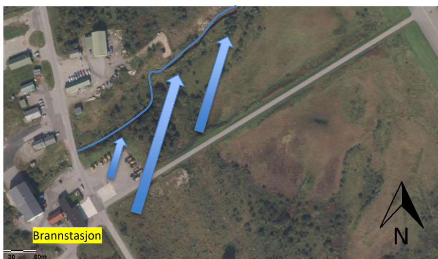
Figur 2.5: Antatt strømningsretning til grunnvannet i området ved brannstasjonen, vist med blå piler. Bekken er vist med blå, heltrukken linje.
