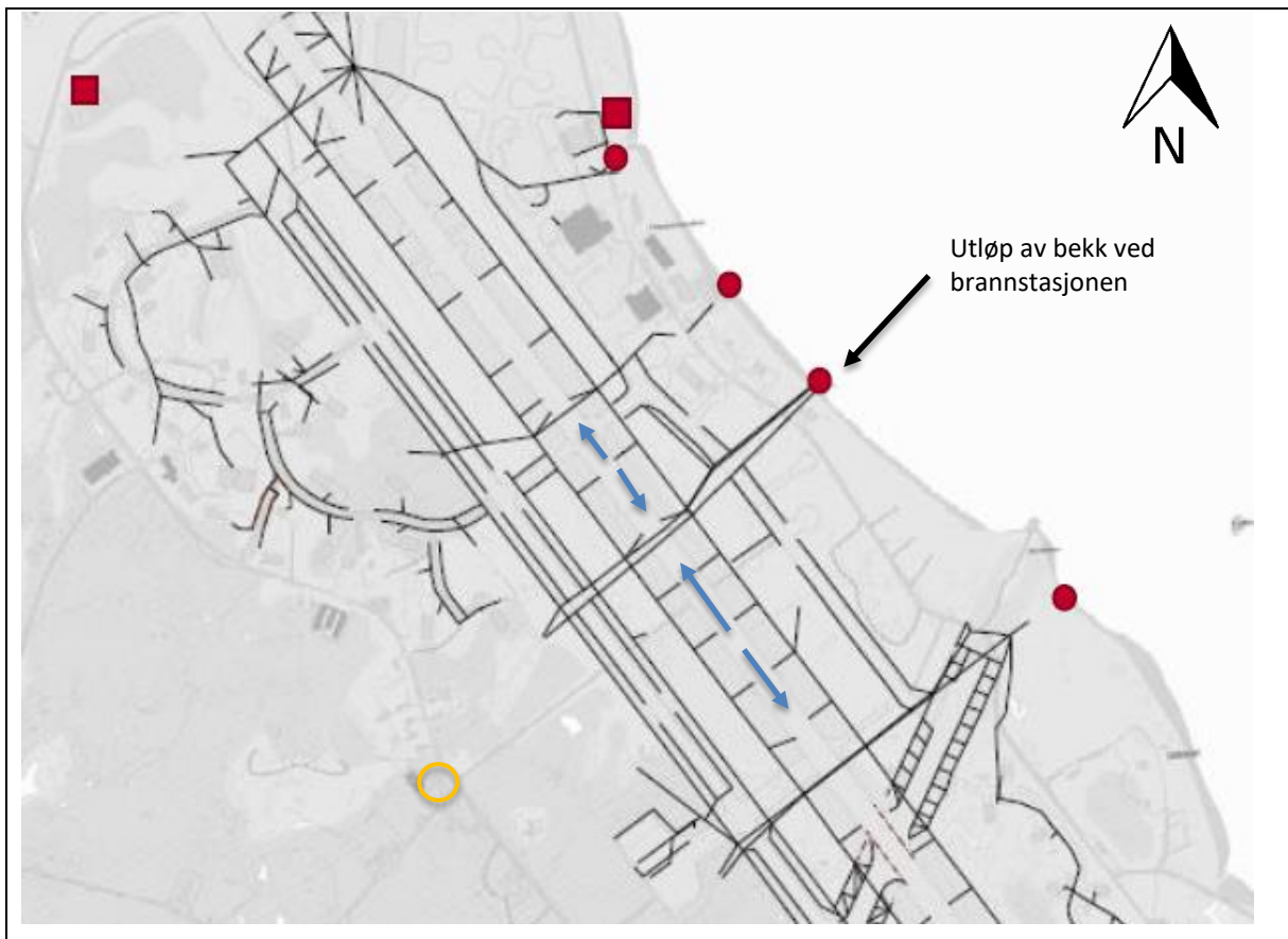
Figur 2.4: Overvannssystemet på den nordlige og midtre del av flystasjonen på Andøya /12/. Utløpene av kulvertene/overvannsledningene er markert med røde punkt. Brannstasjonen er vist med oransje sirkel. De blå pilene angir antatt dreneringsretning til overvannet på flystripen.
