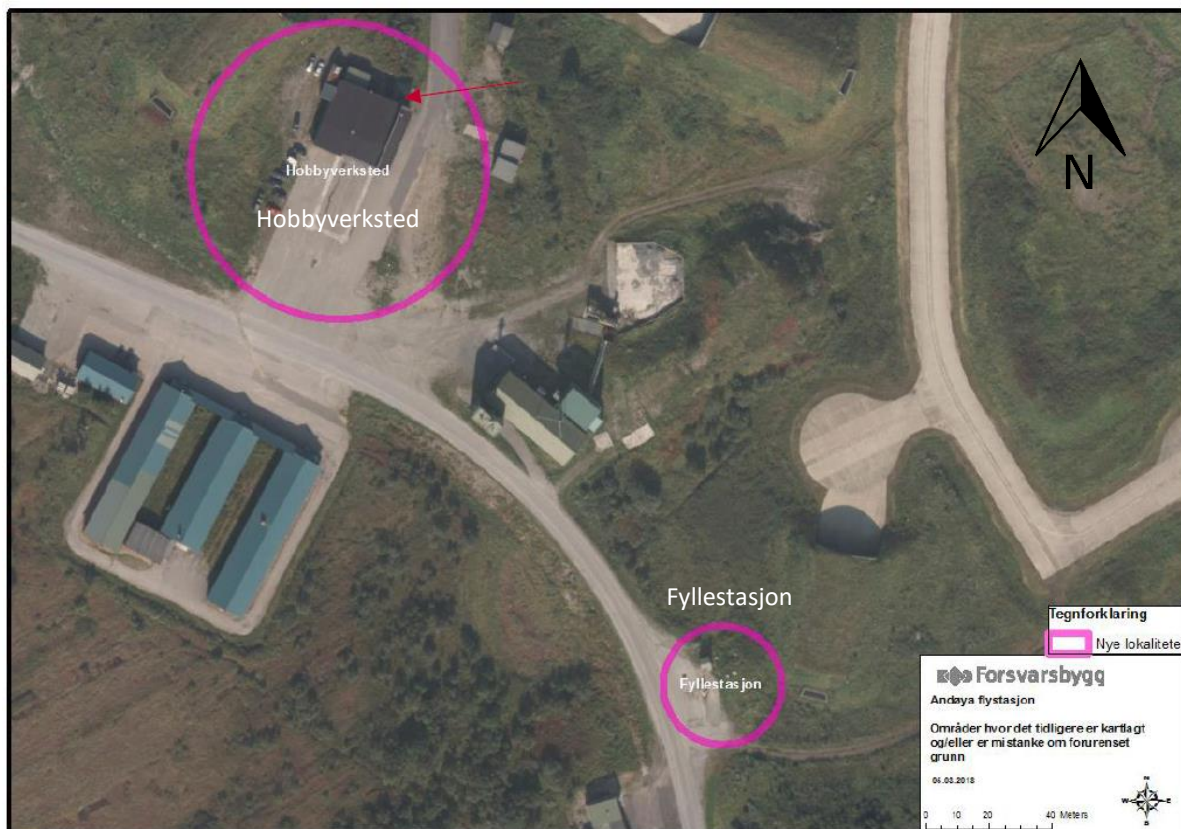
Figur 2.3: Flyfoto som viser hobbyverkstedet med asfaltert dekke i front, der plassering av spilloljetank er vist med rød pil. Fyllestasjonen er lokalisert sørøst for verkstedet. Figuren er hentet fra rapporten fra den innledende miljøkartleggingen /1/.
