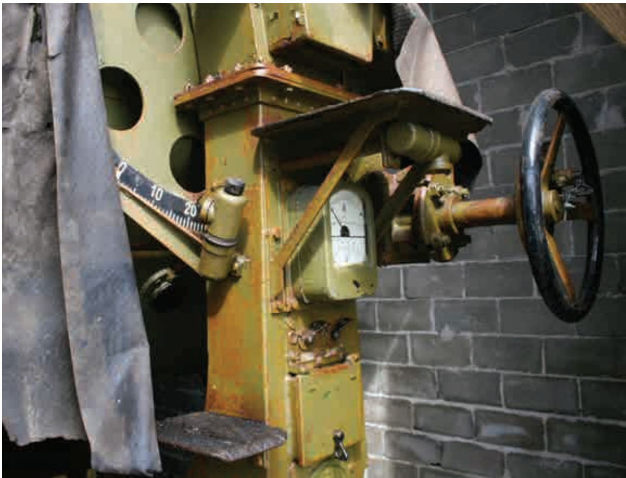
Lyskasteren fra 1936 dreier 360 grader rundt, er på skinner og kan rulles ut av huset
