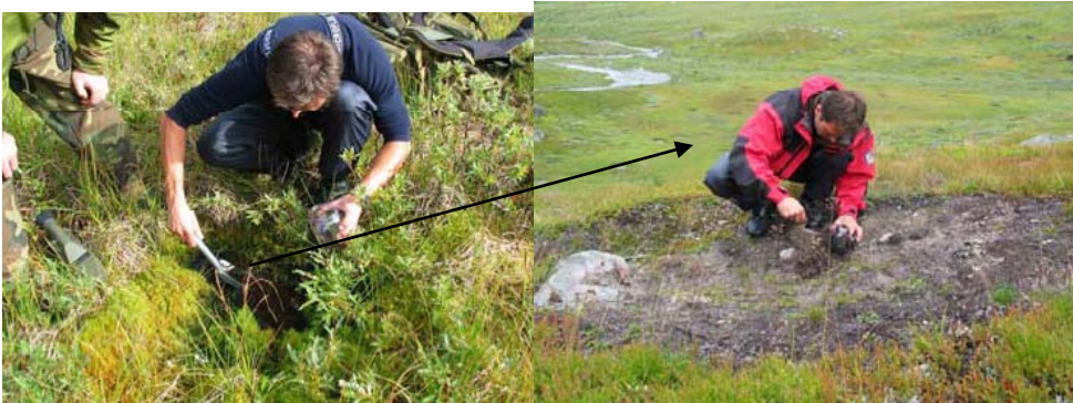
Figur 4-7: Liveltskardet. Til venstre: Krater med 2300 mg/kg hvitt fosfor i område 5. Til høyre: prøvetaking av tørt krater – i bakgrunnen er målområde 5. Pil viser hvor krateret med høy konsentrasjon ligger på myra i bakkant. Foto Grete Rasmussen.
