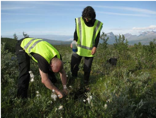
Figur 4-10: Mauken. Innhenting av vegetasjon i krater med høyest målte hvitt fosfor konsentrasjon.
