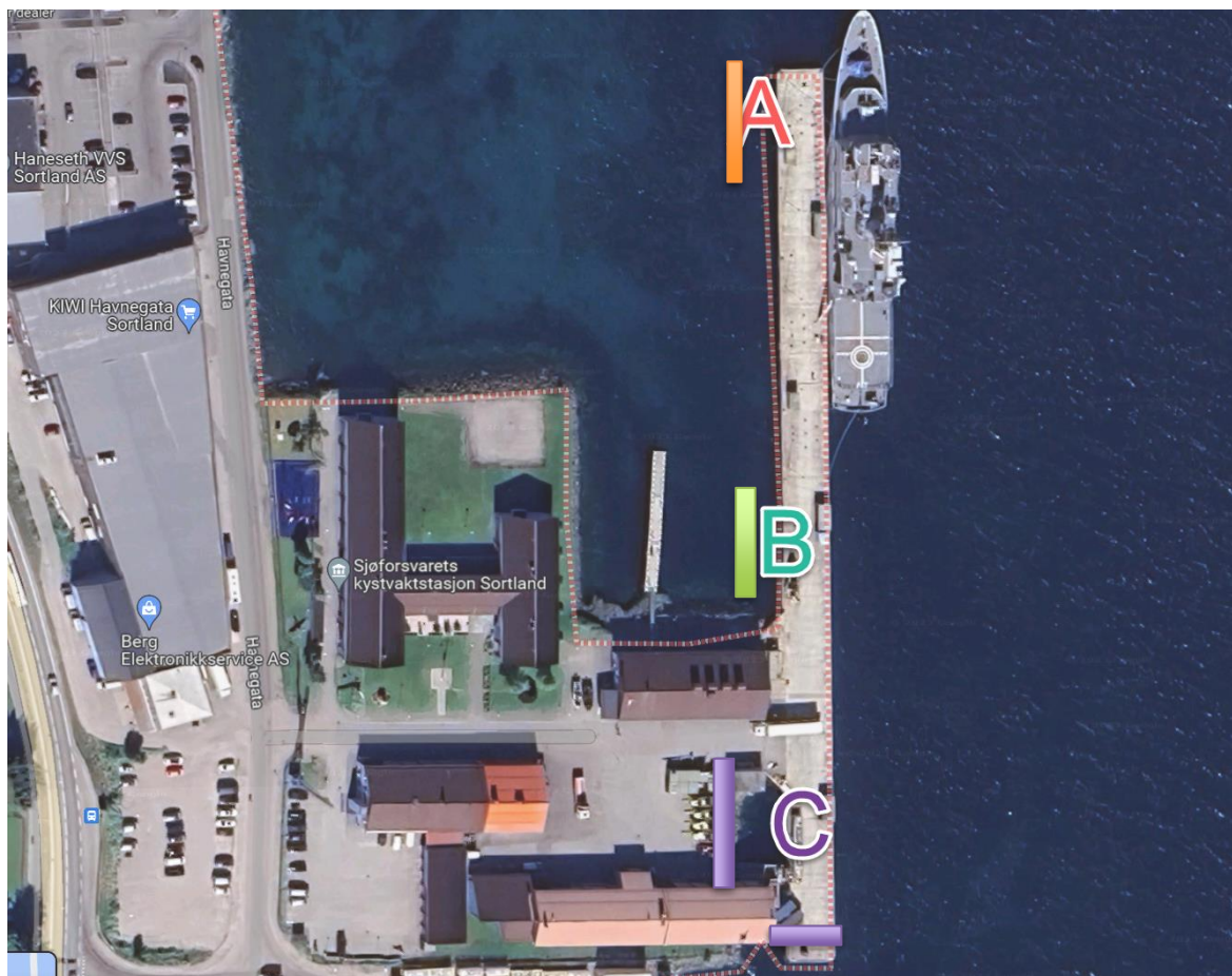
Figur 2: Kildeposisjoner brukt for beregning (A, B og C). De tilhørende plasserte støyskjermene er angitt med samme farge som kilden den er beregnet for.
